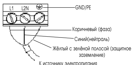
120/240В, 3 провода Европейская цветовая кодировка
