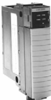
Семейство аналоговых сервомодулей ControlLogix – это недорогая опция управления движением с замкнутым и разомкнутым контуром управления для устройств, поддерживающих аналоговый интерфейс. Аналоговые сервомодули обеспечивают задающий аналоговый выходной сигнал  $\pm 10V$  и поддерживают различные устройства обратной связи по положению. Один модуль поддерживает до двух осей, могут использоваться несколько модулей, контролирующих до 32 осей на один контроллер ControlLogix.
