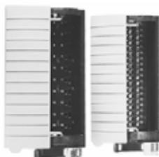
Съемные клеммные блоки (RTB) 1756 обеспечивают гибкость подключения между Вашим оборудованием и модулями ввода/вывода 1756. RTB устанавливается во фронтальную часть модуля ввода/вывода. Тип модуля задает, какой RTB Вам необходим. Вы можете выбрать RTB с винтовым зажимом (screw-clamp) или с пружинным зажимом (spring-clamp).
